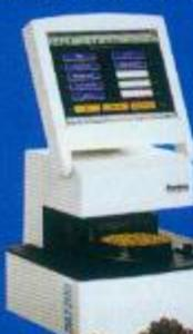
DA7200 型近红外分析仪采用二极阵列、连续光谱、固定光栅结合的成像技术,并行处理所有波长的信息。适用于农业育种、粮油检测、面粉加工、食品行业等原料和产品的品质分析。
